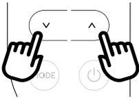
La temperatura puede visualizarse en °C o °F. Para cambiar la unidad de medida de temperatura pulse ambas teclas de disminución/aumento (C3) y ^ (C4) durante unos 10 seg.
