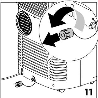
Cuando el aparato esté vacío, sustituir las tapas.
