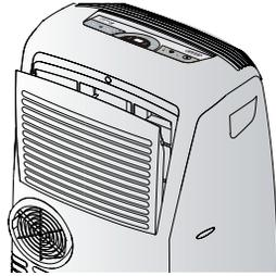
Para quitar el polvo depositado en el filtro, utilice una aspiradora. Si está muy sucio, sumérgalo en agua tibia aclarándolo varias veces. Mantenga la temperatura del agua por debajo de los 40°C. Después de haberlo lavado, seque el filtro antes de volverlo a colocar. Ponga el filtro en el alojamiento específico para colocarlo de nuevo.
