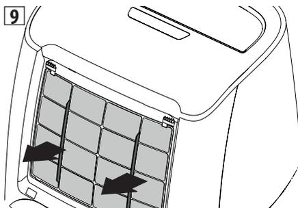
Use una aspiradora para quitar el polvo depositado en el filtro. Si está muy sucio, sumergir en agua tibia y enjuague varias veces. La temperatura del agua debe mantenerse por debajo de 104°F. Después de lavar el filtro, dejar secar. Al sustituir, colocar el filtro en su receptáculo.
