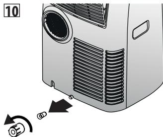
Cuando el aparato esté vacío, sustituir las tapas.
