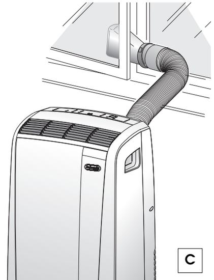
Limite todo lo posible la longitud y las curvas de el tubo de aire evitando cualquier estrangulamiento.
