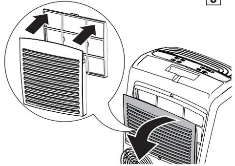
Para quitar el polvo depositado en el filtro, utilice un aspirador. Si está muy sucio, sumérgalo en agua tibia aclarándolo varias veces. Mantenga la temperatura del agua por debajo de los 104°F (40°C).
