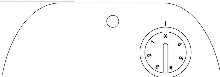
El aparato se enciende girando el selector en el sentido de las agujas del reloj hasta que se detiene en la posición máxima; para apagar totalmente el aparato, girar el selector hasta la posición mínima y sucesivamente sacar la clavija de la toma de corriente.
