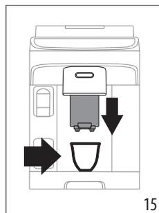
2. Coloque una taza bajo las boquillas del surtidor de café (A17) (fig. 15);
