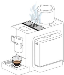
*Se trata del vapor que desprende la dosis de café utilizada y que se elimina automáticamente en el cajón de posos de la máquina. Forma parte del funcionamiento normal y correcto de la máquina.*
