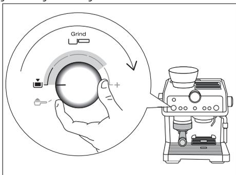
Ajustando este botón, se puede adaptar la molienda a cualquier tipo de café y, en el tiempo, al deterioro progresivo de las muelas.
