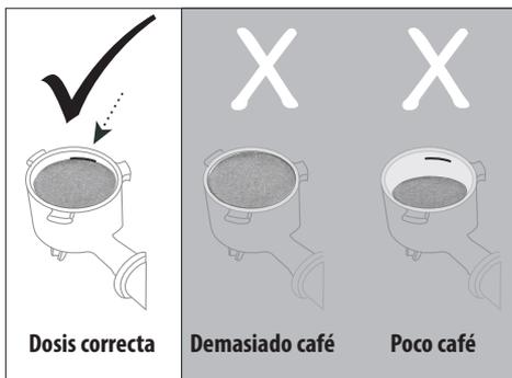
Después de la primera molienda, gire gradualmente el botón (B2) partiendo de la posición ☑ "min" (véase siguiente imagen) hasta alcanzar la dosis correcta en función del tipo de café: la posición ideal se identificará dentro del sector evidenciado en gris en la siguiente imagen.
