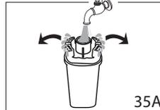
3. Para activar el filtro, haga pasar agua del grifo por el orificio del filtro, tal como se indica en la figura, hasta que el agua salga por las aberturas laterales durante más de un minuto (fig. 35A).
