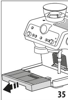
La bandeja recogegotas tiene un indicador flotante del (A14) nivel de agua contenida. Antes de que este indicador empiece a asomar de la bandeja apoyatazas, es necesario vaciar la bandeja y limpiarla, en caso contrario el agua puede rebosar por el borde y dañar la máquina, la bandeja de apoyo o la zona circundante.
