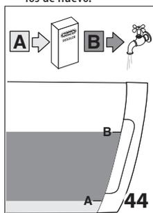
7. Eche en el depósito de agua el descalcificador hasta alcanzar el nivel **A** (que corresponde a un envase de 100 ml) indicada en el revés del depósito (fig. 44); y eche entonces agua (un litro) hasta alcanzar el nivel **B** (fig. 44); vuelva a introducir el depósito de agua.
