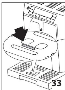
La bandeja recogegotas (A12) tiene un indicador flotante (de color rojo) (A13 - de color rojo) del nivel de agua contenida (fig. 33). Antes de que este indicador empieza a asomar por la bandeja apoyatazas es necesario vaciarla y limpiarla, en caso contrario el agua puede rebosar por el borde y dañar la máquina, la superficie de apoyo o la zona circundante. Para extraer la bandeja
