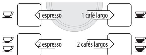
5. La preparación empieza y en el panel de control permanece encendido el piloto correspondiente al botón seleccionado.
