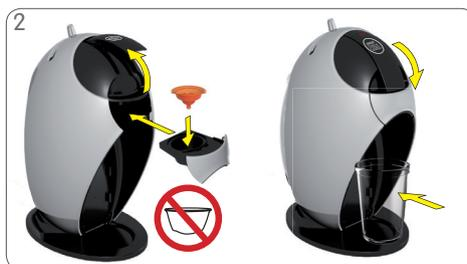
Abra la manija de bloqueo. Asegúrese de que la herramienta de enjuague esté en el porta cápsulas y que el porta cápsulas esté en la máquina. Cierre la manija de bloqueo. Coloque un recipiente grande vacío debajo de la salida de café.
