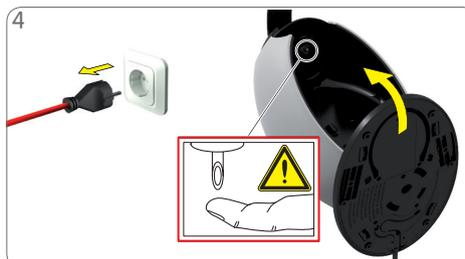
Desenchufe el enchufe de alimentación. Retire la rejilla de goteo y la bandeja de goteo. Inclíne la máquina para acceder mejor al inyector. ¡No toque nunca el inyector con los dedos!
