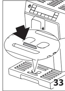
La bandeja recogegotas (A12) tiene un indicador flotante (de color rojo) (A13 - de color rojo) del nivel de agua contenida (fig. 33). Antes de que esto indicador empieza a asomar por la bandeja apoyatazas es necesario vaciarla y limpiarla, en caso contrario el agua puede rebosar por el borde y dañar la máquina, la superficie de apoyo o la zona circundante.
