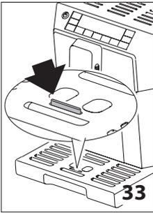
La bandeja recogegotas (A12) tiene un indicador flotante (de color rojo) (A13 - de color rojo) del nivel de agua contenida (fig. 33). Antes de que este indicador empieza a asomar por la bandeja apoyatazas es necesario vaciarla y limpiarla, en caso contrario el agua puede rebosar por el borde y dañar la máquina, la superficie de apoyo o la zona circundante. Para extraer la bandeja
