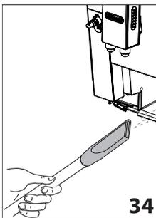
1. Controle periódicamente (una vez al mes) que en el interior de la máquina (al que puede accederse una vez extraída la bandeja recogegotas - A12) no esté sucio. Si es necesario, elimine los restos de café con el pincel suministrado (C5) y una esponja.
