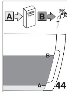
7. Eche en el depósito del agua el descalcificador hasta alcanzar el nivel **A** (que corresponde a un envase de 100 ml) indicado en el revés del depósito (fig. 44); y eche entonces agua (un litro) hasta alcanzar el nivel **B** (fig. 44); vuelva a introducir el depósito de agua.
