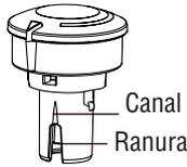
5. Aclarar el interno de la posición de la manivela de regulación de espuma con agua (ver figura).
