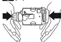
Si resulta difícil colocar el grupo de infusión, (antes de colocarlo) se debe llevar a la dimensión correcta presionando las dos palancas como se muestra en la figura.
