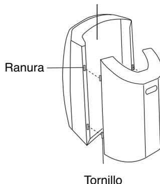
Luego alinee y coloque el tornillo de la sección derecha dentro de su ranura.
