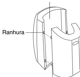
2) Para montar a tampa traseira, alinhe e coloque os dois parafusos de localização no lado esquerdo da tampa posterior nas ranhuras correspondentes no gabinete. Em seguida, alinhe e coloque o parafuso do lado direito na ranhura.
