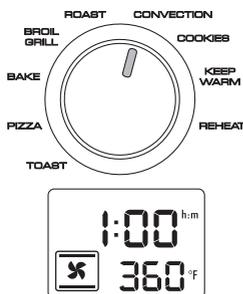
Gire el botón selector Tiempo/temperatura/tostar color/pizza tamaño/rodajas/bandeja (N) para programar el tiempo deseado. El tiempo por defecto es 1:00 (hora), el ajuste de temperatura por defecto es 360°F.
