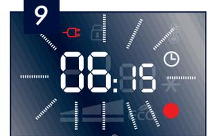
9 La última configuración de la hora destellará. Gire el mando hacia la derecha hasta la siguiente configuración de hora. Pulse el mando para confirmar. Repita los pasos 8 y 9 para las configuraciones adicionales para abarcar las 24 horas. El último ajuste de hora debe ser **00:00** (medianoche). Si el temporizador está configurado correctamente, sonará una señal acústica (bip) prolongada para confirmar.
