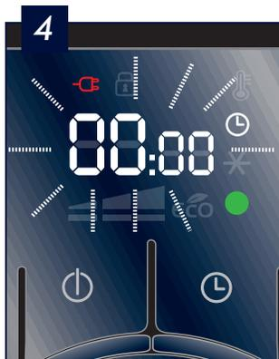
La pantalla muestra la regulación de la temperatura (verde T1 o rojo T2) que se ha programado a partir de la medianoche (**00:00**).
