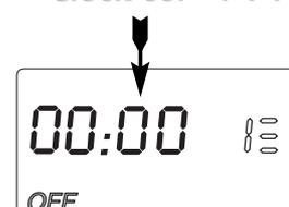
Para programar la hora de inicio del programa, presione el pulsador **"Clock Set"** hasta seleccionar la hora en la que desea que el aparato empiece a funcionar (consulte el párrafo **"Poner en hora el reloj"**), a continuación confirme la hora de encendido presionando de nuevo el pulsador **"P"** (ej. 8:30).
