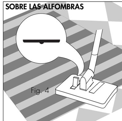
Determinar la posición de las cerdas accionando la palanca presente en la boca de aspiración.
