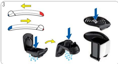
3 Enjuague la máquina: Siga las instrucciones de 5. «PRIMERAPUESTA EN FUNCIONAMIENTO» en la página 9. Limpie con líquido detergente y agua potable fresca ambos lados del soporte de la cápsula. Enjuague la bandeja recoge gotas con agua potable fresca y límpiela con un cepillo limpio seguro para alimentos.
