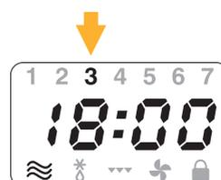
Seleccione el nivel de potencia de las microondas pulsando repetidamente el botón **POWER LEVEL** (5) hasta que parpadea la potencia elegida, expresada en números en la parte superior de la pantalla. Para elegir la potencia, consulte siempre las tablas contenidas en el capítulo 3.
