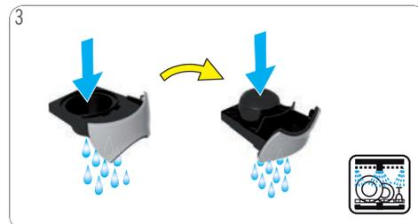
Pulire con detersivo liquido e acqua potabile fresca su entrambi i lati del supporto per capsule. In alternativa lavare in lavastoviglie. Asciugarlo in seguito.
