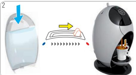
Controllare se il serbatoio dell'acqua contiene abbastanza acqua potabile fresca. In caso contrario, riempire con acqua potabile fresca e spostare la leva di selezione nella posizione "HOT" rispettivamente "COLD" per continuare la preparazione. Se il serbatoio dell'acqua è pieno procedere come descritto nel «NESSUN LIQUIDO FUORIESCE – CAPSULA / INIETTORE BLOCCATO?» a pagina 16.
