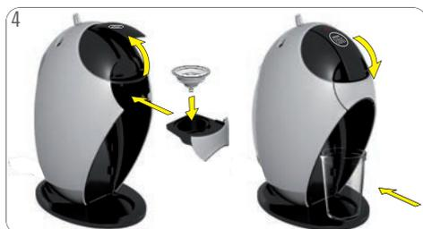
Aprire la leva di blocco. Collocare l'utensile per il risciacquo nel supporto per capsule. Inserire il supporto per capsule nella macchina. Chiudere la leva di blocco. Posizionare un contenitore grande vuoto sotto l'uscita del caffè.
