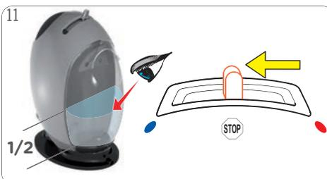
11 Controllare visivamente quando il serbatoio dell'acqua è mezzo pieno. Spostare la leva di selezione in posizione "STOP".
