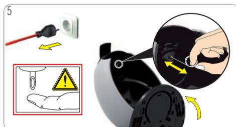
Scollegare la spina di alimentazione! Rimuovere la griglia raccogli-gocce e lo sgocciolatoio. Inclinare la macchina per meglio poter accedere all'iniettore. Non toccare mai l'iniettore con il dito! Pulire l'iniettore con l'ago di pulizia. Seguire le istruzioni in 8. «Decalcificare almeno ogni 3-4 mesi» a pagina 13.
