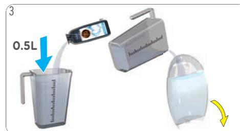
3 Mescolare 0.5 litro di acqua potabile fresca con il decalcificante in un dosatore. Versare la soluzione decalcificante nel serbatoio dell'acqua e inserirlo nella macchina.
