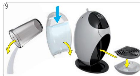
Contenitore vuoto. Riempire il serbatoio con acqua potabile fresca. Inserire il serbatoio dell'acqua nella macchina. Posizionare la griglia raccogli-gocce sullo sgocciolatoio. Inserire in seguito lo sgocciolatoio nella posizione desiderata.
