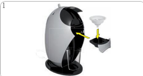
Collocare l'utensile per il risciacquo nel supporto per capsule. Inserire il supporto per capsule nella macchina.
