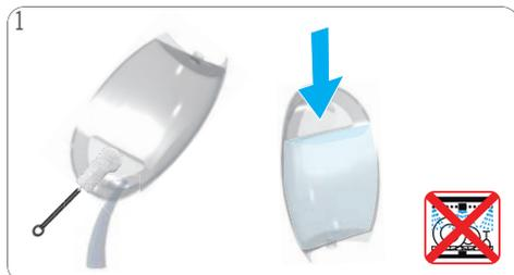
Risciacquare e pulire il serbatoio dell'acqua. Utilizzare uno spazzolino pulito adatto ad uso alimentare e un detersivo liquido se necessario. Riempirlo in seguito con acqua potabile fresca e inserirlo nella macchina. Il serbatoio dell'acqua non può essere lavato nella lavastoviglie!
