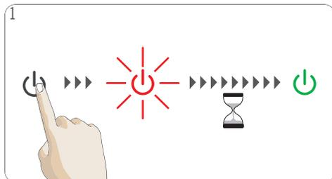
Controllare se il serbatoio dell'acqua contiene abbastanza acqua potabile fresca. Accendere la macchina. Il pulsante di accensione e spegnimento inizia a lampeggiare in rosso mentre la macchina è in fase di riscaldamento per circa 40 secondi. In seguito il pulsante di accensione e spegnimento rimane fisso sul verde. La macchina è pronta all'uso.
