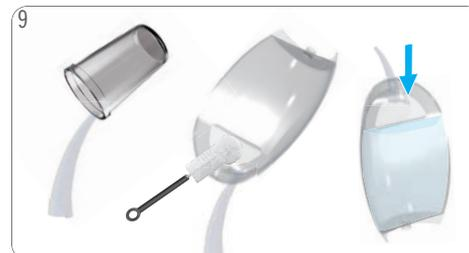
9 Contenitore vuoto e pulito. Risciacquare e pulire il serbatoio dell'acqua. Utilizzare uno spazzolino pulito adatto ad uso alimentare e un detersivo liquido se necessario. Riempirlo in seguito con acqua potabile fresca e inserirlo nella macchina.
