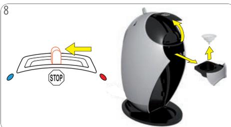
Dopo circa 60 secondi, spostare la leva di selezione in posizione "STOP". Aprire la leva di blocco. Estrarre il supporto per capsule. Rimuovere l'utensile per il risciacquo. Reinserrire il supporto per capsule.
