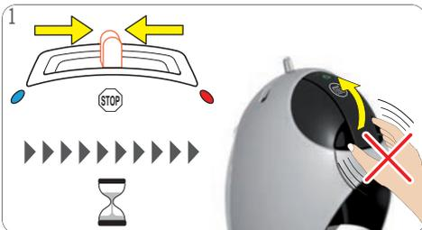
Tenere sempre la macchina in posizione verticale! Per interrompere la preparazione, spostare la leva di selezione in posizione "STOP". Non aprire forzando la leva di blocco. La macchina rilascia la pressione. Attendere 20 minuti per ridurre la pressione.
