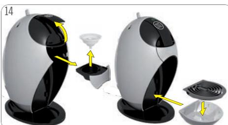
14 Aprire la leva di blocco. Estrarre il supporto per capsule. Rimuovere l'utensile per il risciacquo. Sciacquare il supporto per capsule con acqua fresca potabile da entrambi i lati. Reinserire il supporto per capsule. Contenitore vuoto e pulito. Posizionare la griglia raccogli-gocce sullo sgocciolatoio. Inserire in seguito lo sgocciolatoio nella posizione desiderata.
