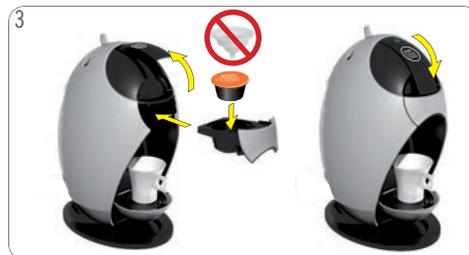
Aprire la leva di blocco. Estrarre il supporto per capsule. Assicurarsi che l'utensile per il risciacquo non sia all'interno. Inserire la capsula nell'apposito supporto. Reinserirlo nella macchina. Chiudere la leva di blocco.
