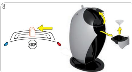
Au bout de 60 secondes environ, poussez le levier de sélection en position « STOP ». Ouvrez la poignée de verrouillage. Sortez le porte-capsule. Enlevez l'accessoire de rinçage. Réinsérez le porte-capsule.
