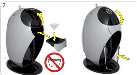
Ouvrez la poignée de verrouillage. Assurez-vous que l'outil de rinçage est dans le porte-capsule et que celui-ci est dans la machine. Fermez la poignée de blocage. Placez un grand récipient vide sous la sortie café.
