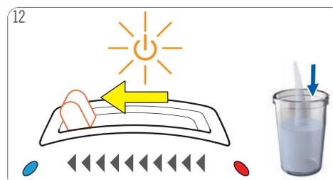
Poussez le levier de sélection en position « COLD ». Le rinçage démarre. Le bouton marche/arrêt clignote en orange.
