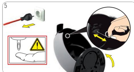
Débranchez la fiche de courant ! Enlevez la grille et le bac d'égouttage. Pour un meilleur accès à l'injecteur, penchez la machine. Ne touchez jamais l'injecteur avec les doigts ! Nettoyez l'injecteur avec une aiguille de nettoyage. Suivez les instructions au chapitre 8. «Détartrage tous les 3 à 4 mois au moins» à la page 13.
