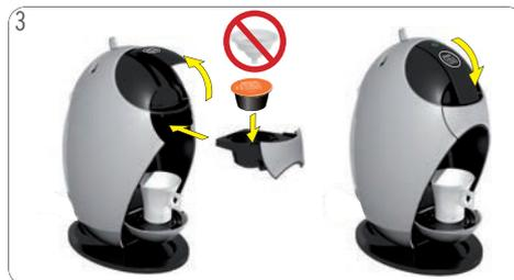
Ouvrez la poignée de verrouillage. Sortez le porte-capsule. Assurez-vous que l'outil de rinçage n'est pas à l'intérieur. Insérez une capsule dans le porte-capsule. Réintroduisez celui-ci dans la machine. Fermez la poignée de blocage.
