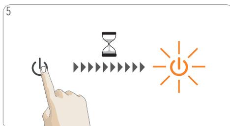
5 Appuyez sur le bouton marche/arrêt pendant 5 secondes au moins. Le bouton Marche/Arrêt commence à clignoter en orange. La machine passe en mode détartrage.
