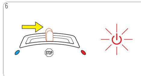
Au bout de 60 secondes environ, poussez le levier de sélection en position « STOP ». La machine arrête le rinçage. Le bouton marche/arrêt clignote en rouge pendant 5 secondes environ.
