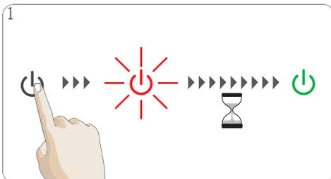
Vérifiez si le réservoir d'Eau contient assez d'eau fraîche. Démarrez la machine. Le bouton Marche/Arrêt commence à clignoter en rouge quand la machine se met en température pendant 40 secondes environ. Ensuite, le bouton marche/arrêt s'éclaire en vert. La machine est opérationnelle.
