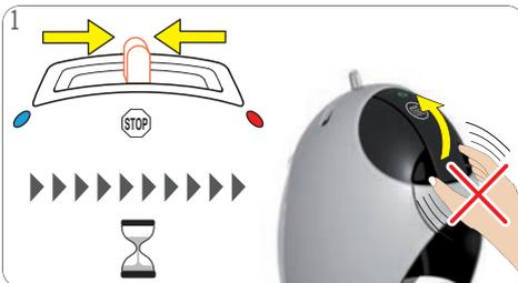
Laissez toujours la machine debout ! Poussez le bouton de sélection en position « STOP ». Ne forcez pas pour ouvrir la poignée de verrouillage. Elle évacue la pression. Attendez 20 minutes pour diminuer la pression.
