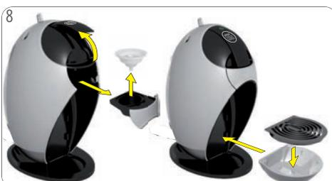
Ouvrez la poignée de verrouillage. Sortez le porte-capsule. Enlevez l'accessoire de rinçage. Réinsérez le porte-capsule. Placez la grille d'égouttage sur le bac d'égouttage. Insérez le bac d'égouttage dans la position souhaitée. Si le réservoir contient de l'eau, videz-le.
