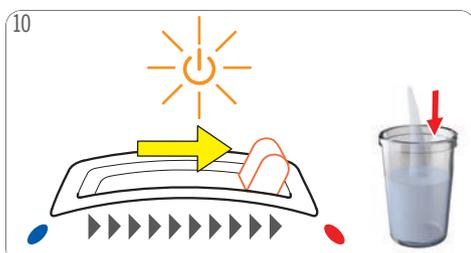
10 Empuje la palanca de selección a la posición "CALIENTE". Se inicia el enjuague de la máquina. El botón de encendido parpadea en naranja.
