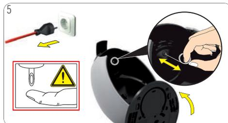
5 Desenchufe el enchufe de alimentación. Retire la rejilla recoge gotas y la bandeja recoge gotas. Inclíne la máquina para acceder mejor al inyector. **¡No toque nunca el inyector con los dedos!** Limpie el inyector con la aguja de limpieza. Siga las instrucciones de 8. «Descalcificar al menos cada 3 ó 4 meses» en la página 13.
