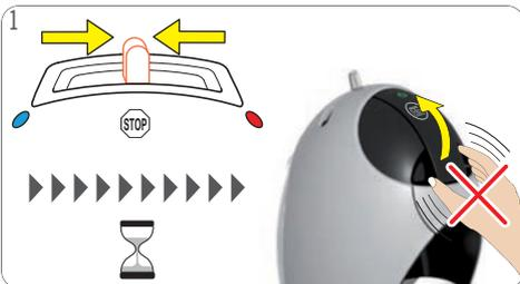
1 **¡Mantenga siempre la máquina vertical!** Para detener la preparación, mueva la palanca de selección a la posición "PARADA". No abra la manija de bloqueo ejerciendo fuerza. La máquina libera presión. Espere durante 20 minutos para reducir la presión.
