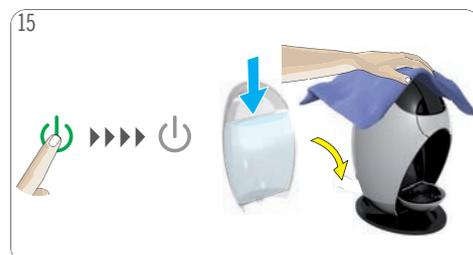
15 Apague la máquina. Enjuague y limpie el depósito de agua. Llene el depósito con agua potable fresca. Insértelo de nuevo en la máquina. Limpie la máquina con un paño húmedo y suave. Séquela después con un paño seco y suave.
