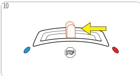
Manténgase al lado de la máquina a lo largo de la preparación. Después de alcanzar el nivel deseado, mueva la palanca de selección a la posición "PARADA". La máquina detiene la preparación.
