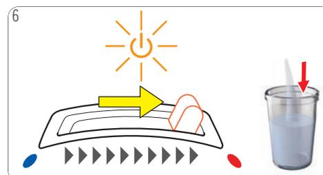
6 Empuje la palanca de selección a la posición "CALIENTE". Se inicia el enjuague de la máquina. El botón de encendido parpadea en naranja.
