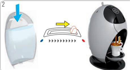
Compruebe si el depósito de agua contiene suficiente agua potable fresca. Si no es así, rellénelo con agua potable fresca y mueva la palanca de selección a la posición "CALIENTE" o "FRÍA" para continuar la preparación. Si el depósito de agua está lleno, proceda como se describe en «NO SALE LÍQUIDO – ¿CAPSULA/INYECTOR BLOQUEADO?» en la página 16.
