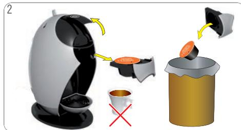
2 No beba el café. Levante la manija de bloqueo. Retire el soporte de la cápsula. Ponga la cápsula usada en el depósito de desperdicios.
