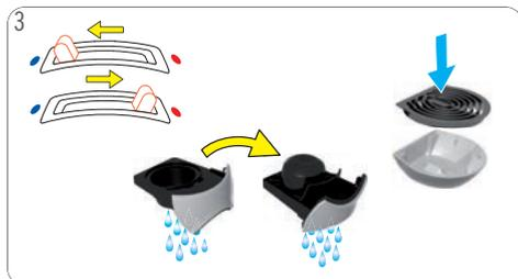
3 Enjuague la máquina: Siga las instrucciones de 5. «PRIMERA PUESTA EN FUNCIONAMIENTO» en la página 8. Limpie con líquido detergente y agua potable fresca ambos lados del soporte de la cápsula. Enjuague la bandeja recoge gotas con agua potable fresca y límpiela con un cepillo limpio seguro para alimentos.
