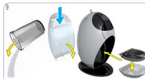
Behälter leeren. Wasserbehälter mit frischem Trinkwasser
