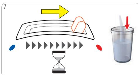
Wahlhebel in Position für "HEISS" bewegen. Die Maschine
