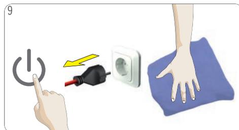
Maschine ausschalten. Maschine ausstecken! Maschine mit einem weichen, feuchten Tuch reinigen. Anschließend mit einem weichen Tuch trocknen.
