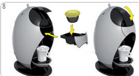
Zweite Kapsel in den Kapselhalter stecken. Kapselhalter wieder in die Maschine einführen. Arretierungsbügel schließen.
