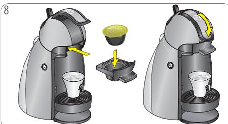
Inserire la seconda capsula nell'apposito supporto. Reinsierlo nella macchina. Chiudere la leva di blocco.
