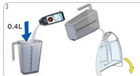
3 Mescolare 0.4 litro di acqua potabile fresca con il decalcificante in un dosatore. Versare la soluzione decalcificante nel serbatoio dell'acqua e inserirlo nella macchina.
