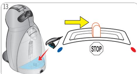
13 Controllare visivamente quando il serbatoio dell'acqua è vuoto. Spostare la leva di selezione in posizione "STOP".
