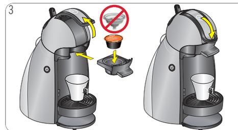
Aprire la leva di blocco. Estrarre il supporto per capsule. Assicurarsi che l'utensile per il risciacquo non sia all'interno. Inserire la capsula nell'apposito supporto. Reinsierlo nella macchina. Chiudere la leva di blocco.
