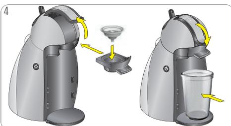
4 Aprire la leva di blocco. Collocare l'utensile per il risciacquo nel supporto per capsule. Inserire il supporto per capsule nella macchina. Chiudere la leva di blocco. Posizionare un contenitore grande vuoto sotto l'uscita del caffè.
