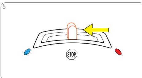
Stare accanto alla macchina durante la preparazione! Dopo aver raggiunto il livello desiderato, spostare la leva di selezione in posizione "STOP". La macchina interrompe automaticamente la preparazione.
