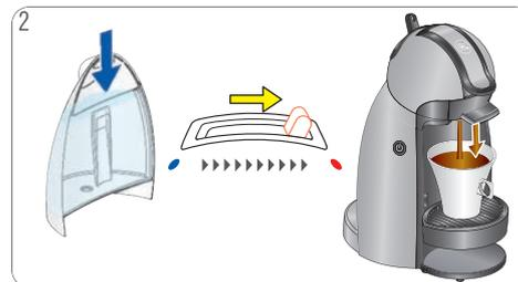
Controllare se il serbatoio dell'acqua contiene abbastanza acqua potabile fresca. In caso contrario, riempire con acqua potabile fresca e spostare la leva di selezione nella posizione "HOT" rispettivamente "COLD" per continuare la preparazione. Se il serbatoio dell'acqua è pieno procedere come descritto nel 9.2 «NESSUN LIQUIDO FUORIESCE – CAPSULA / INIETTORE BLOCCATO?» a pagina 16.
