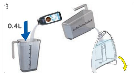
3 Mezcle 0.4 litros de agua potable fresca con un descalcificador en un recipiente de medición. Vierta la solución de descalcificación en el depósito de agua e inserte el depósito de agua en la máquina.
