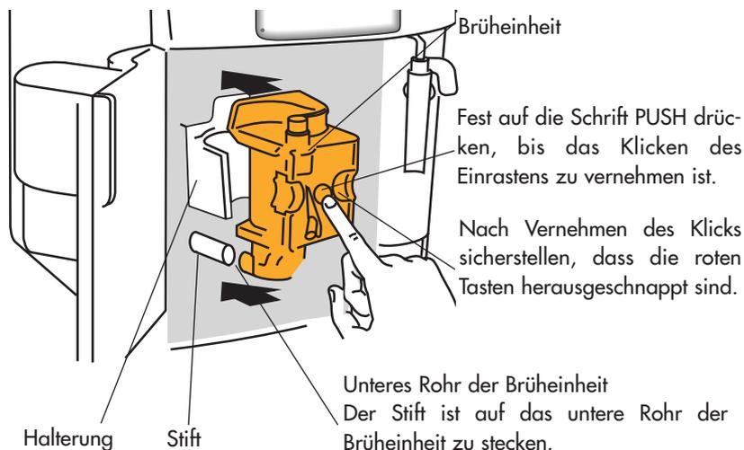
Sicherstellen, dass die beiden roten Tasten herausgeschnappt sind, da sich sonst die Klappe nicht schließen lässt.
