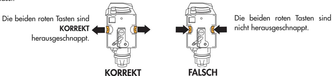
**HINWEIS 1:** Wenn die Brühseinheit nicht korrekt eingesetzt ist, d.h. bis das Einrasten durch ein Klicken hörbar ist, und die roten Tasten nicht richtig herausgeschnappt sind, kann die Serviceklappe nicht geschlossen werden.
