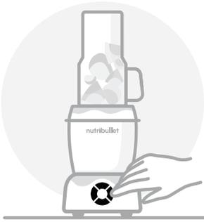
Wählen Sie am Bedienfeld eine Drehzahl oder das Programm **EXTRACT**, um mit dem Mixen zu beginnen. Das Programm schaltet sich automatisch aus. Während des Betriebs sind die Tasten beleuchtet.
