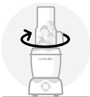
Drehen Sie den Becher auf den Kopf und setzen Sie ihn auf den Motorsockel; drehen Sie den Becher nach rechts, um ihn in seiner Position zu arretieren.
