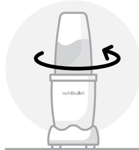
Entfernen Sie den Becher, indem Sie ihn nach unten drücken und langsam nach links drehen.
