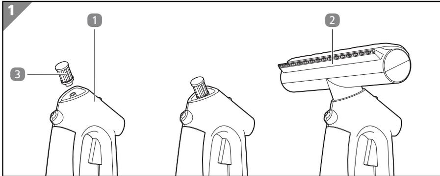
1. Stecken Sie den Filter **3** auf das Grundgerät **1**.
