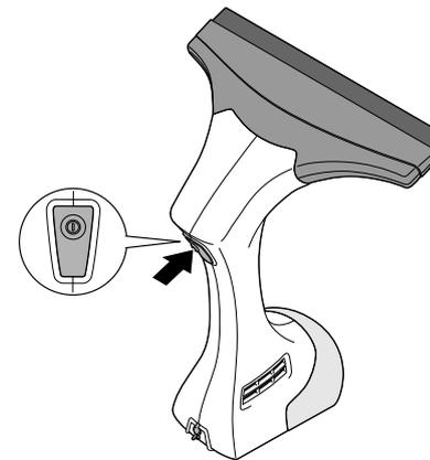
1. Setzen Sie den Fenstersauger mit senkrechtem Handteil an die feuchte Fläche an und drücken Sie die Ein-/Ausschalttaste **ⓘ**, um das Gerät einzuschalten. Die Kontrollleuchte leuchtet dauerhaft rot.
