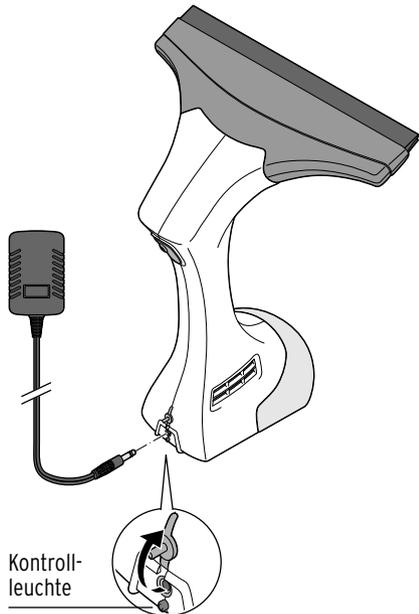
1. Stecken Sie den kleinen Stecker des Ladekabels in die Buchse unten am Gerät.
