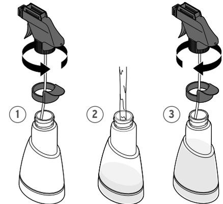
1. Füllen Sie die gewünschte Reinigungslösung in die Flasche ein und schrauben Sie den Sprühkopf wieder auf die Flasche. Der Ring sorgt dafür, dass sich der Sprühkopf während des Gebrauchs nicht versehentlich losschraubt.
