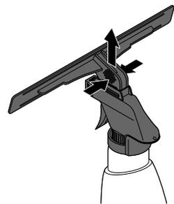
2. Drücken Sie seitlich auf die geriffelten Flächen und ziehen die Halterung für das Microfaser-Pad ab.
