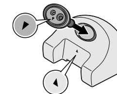
1. Kippen Sie den Wassertank leicht schräg nach unten, um ihn vom Gehäuse zu lösen.
