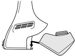
4. Setzen Sie den Wassertank leicht schräg unten auf den Steg ...
