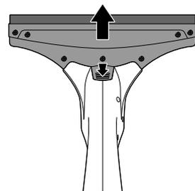
1. Nehmen Sie die Saugdüse ab, indem Sie auf die geriffelte Fläche drücken und gleichzeitig die Saugdüse vom Handteil ab ziehen.
