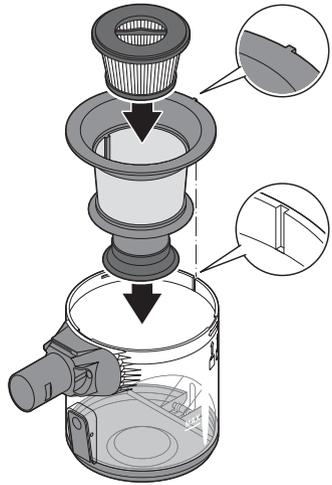
8. Setzen Sie den Auffangbehälter wie abgebildet an den Motorblock. Der Pfeil über dem
