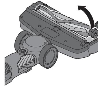
3. Heben Sie die Bürste wie abgebildet an der einen Seite an und ziehen Sie sie aus der Halterung heraus.
