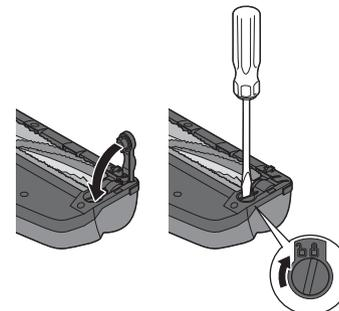
8. Klappen Sie die Abdeckung zu und drehen Sie den Sperrknopf wie abgebildet im Uhrzeigersinn in Richtung
