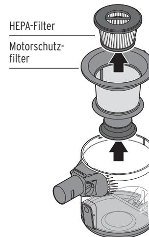
4. Nehmen Sie den Motorschutzfilter heraus und ziehen Sie den HEPA-Filter aus dem Motorschutz-filter.
