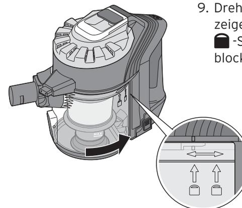
9. Drehen Sie den Auffangbehälter im Uhrzeigersinn, so dass der Pfeil über dem
