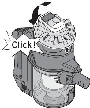
6. Setzen Sie den Deckel zuerst vorne auf und drücken Sie ihn dann hinten im Bereich der Entriegelung an. Er muss hör- und spürbar einrasten.
