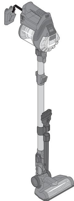
7. Hängen Sie den Motorblock in die Halterung am Saugrohr.
