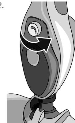
Drehen Sie den Dampfregler so weit wie möglich gegen den Uhrzeigersinn. Die Temperatur-Kontrollleuchte leuchtet, das Gerät heizt auf. Sobald das
