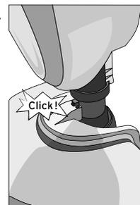
4. Stellen Sie das Gerät aufrecht ab und neigen Sie es dann auf dem Dampf Fuß leicht nach vorne, bis das Drehgelenk am Dampf Fuß einrastet.
