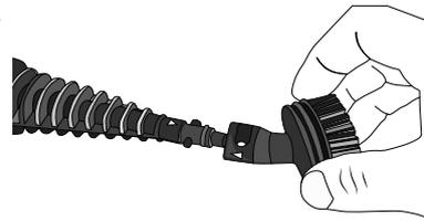
Stecken Sie das gewünschte Zubehörteil vorne auf die Verlängerungstülle auf. Dies geht nur in einer Richtung! Achten Sie auf die beiden unterschiedlich dicken Nasen an der Verlängerungstülle. Diese müssen in die entsprechenden Ausparungen am Zubehörteil eingeschoben werden.
