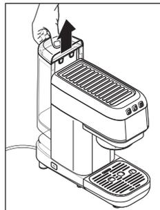
2. Nehmen Sie den Wassertank von der Maschine, indem Sie ihn nach oben abziehen.
