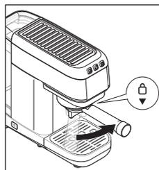
8. Drehen Sie den Siebträger bis zum Anschlag nach rechts in Richtung „Schloss zu“.
