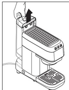
3. Nehmen Sie den Wassertank zum Befüllen
