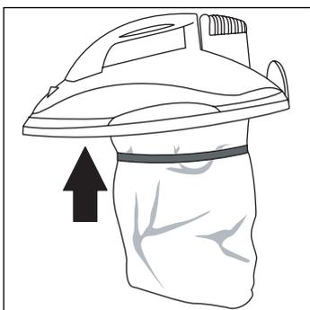
Versichern Sie sich, daß der Motorschutz-Papierfilter am Motorschutzgitter eingesetzt ist.
