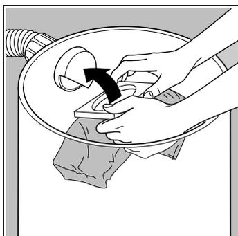
Den Papieraustauschfilter mit großem Fassungsvermögen (29) (nicht bei allen Ausführungen serienmäßig) im Staubbehälter einsetzen und die Pappscheibe am inneren Teil der Ansaugöffnung aufstecken.
