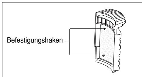
Nachdem der neue Filter eingesetzt worden ist, das Gitter wieder von oben einsetzen.
