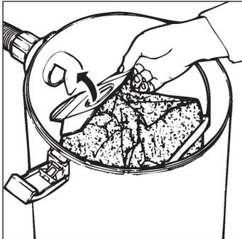
Der Papier-Staubbeutel mit großem Fassungsvermögen wird im Inneren des Gehäuses angebracht, indem der Papprand um den inneren Teil der Saugöffnung gezogen und fest angedrückt wird.
