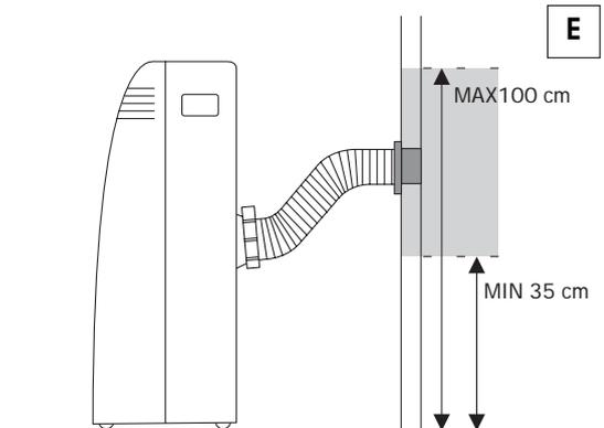
Wenn der Schlauch **12** an dieser Wanddurchführung nicht angeschlossen ist, kann die Öffnung mit dem Stöpsel des Verbindungsflansch **11** verschlossen werden.
