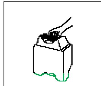
C) Nach dem Auffüllen, den ausziehbaren Schlauch wieder zurückschieben, den Verschluss fest anziehen und den Tank mit der Aufschrift "Front" nach vorn gerichtet wieder einsetzen.
