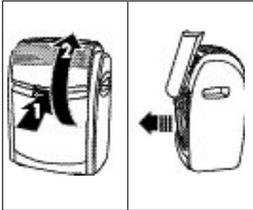
A) Öffnen Sie das Frontpaneel [3], indem Sie in die entsprechende Klappe greifen [2]. Kippen Sie dann den Tank [5] und ziehen Sie ihn nach oben heraus.
