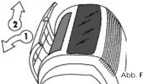
des Filters) heraus, indem Sie ihn am Außen-gitter aushaken. Drücken Sie hierzu die seitlich angebrachten Bügel der Filterhalterung (siehe Abb. G). Verwenden Sie zum Entfernen des abgelagerten Staubs einen Staubsauger. Ist der Filter sehr schmutzig, tauchen Sie ihn in warmes Wasser und spülen ihn mehrmals nach. Die Wassertemperatur muß unter 40°C bleiben.
