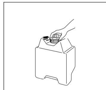
C) Nach dem Auffüllen, den ausziehbaren Schlauch wieder zurückschieben, den Verschuß fest anziehen und den Tank mit der Aufschrift "Front" nach vorn gerichtet wieder einsetzen.
