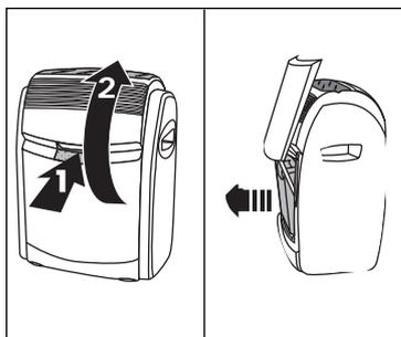
A) Öffnen Sie das Frontpaneel **3**, indem Sie in die entsprechende Klappe greifen **2**. Kippen Sie dann den Tank **5** und ziehen Sie ihn nach oben heraus.
