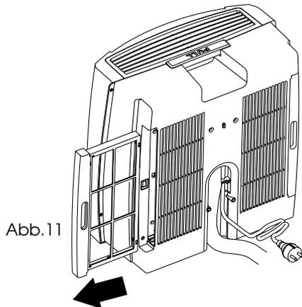
Verwenden Sie zum Entfernen des auf dem Staubfilter abgelagerten Staubs den Staubsauger. Sollten Sie Staubfilter sehr verschmutzt sein, tauchen Sie diese in lauwarmes Wasser und spülen Sie diese dann mehrmals nach.
