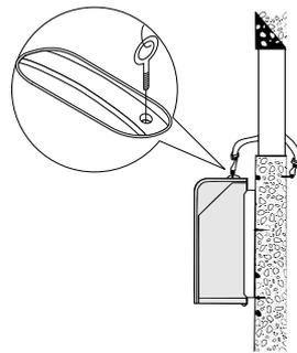
Die externe Einheit kann über oder auf gleicher Ebene mit der Raumeinheit installiert werden, der Höhenunterschied darf jedoch 1,5 m nicht überschreiten. Die Luftansaug- und -ausblasgitter der externen Einheit müssen frei bleiben.
