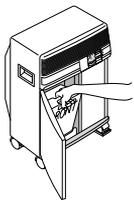
Gerätetür öffnen, den Behälter ankippen und nach oben herausnehmen.
